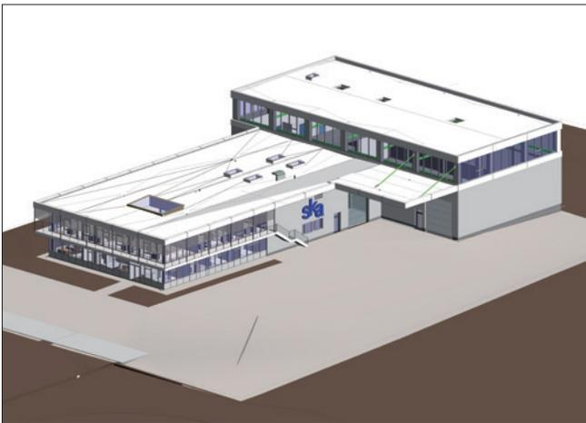
Das 3D-BIM-Modell ist die Basis. Es liefert Geometrien des Baukörpers aber auch alle weiteren für Klimatik und Thermik relevanten Informationen.
